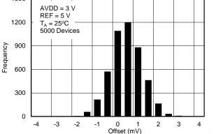
Figure 42. TYPICAL DISTRIBUTION OF OFFSET ERROR
