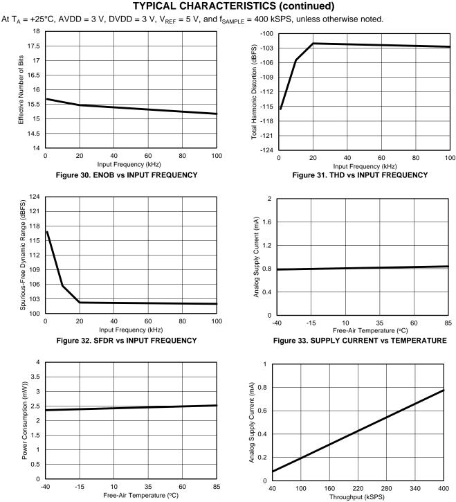
Figure 34. POWER CONSUMPTION vs TEMPERATURE
