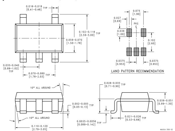
5-Pin SOT-23 Package Order Number LM7301IM5X or LM7301IM5 NS Package Number MA05A
