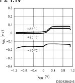
$V_{os}$  vs  $V_{cm}$  $V_{s} = \pm 2.5V$
