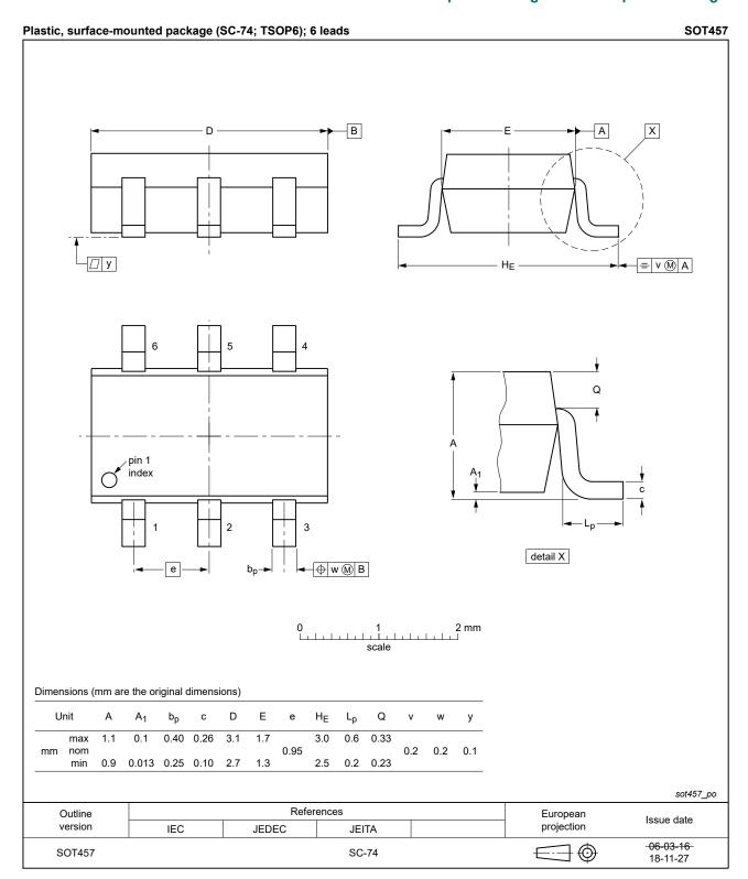
Fig. 20. Package outline SOT457 (SC-74; TSOP6)
