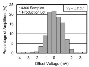
Figure 14. Offset Voltage Production Distribution
