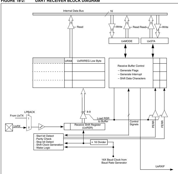
**FIGURE 18-2: UART RECEIVER BLOCK DIAGRAM**
