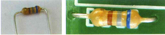
Рис.4. Монтаж резистора R2 набора NS073
