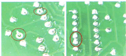
Рис. 16. Возможные дефекты пайки
