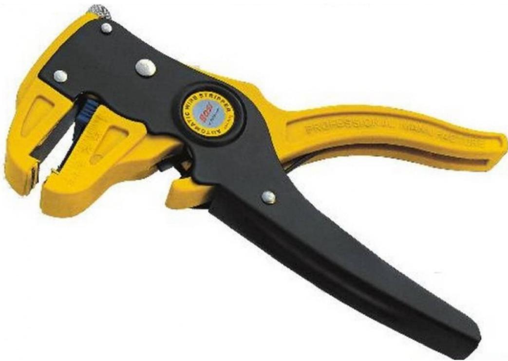
BS440311 Автоматический ручной стриппер - инструмент для зачистки кабеля. Предназначен для снятия изоляции с круглых проводов сечением 0.5–6.0 мм<sup>2</sup>, с плоских проводов шириной до 8 мм , резки проводов сечением до 6 мм<sup>2</sup>. Автоматическая настройка на нужный размер и толщину изоляции провода, ограничитель длины снятия изоляции, винт регулировки прижимного усилия лезвий.
