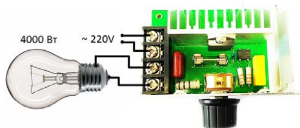
Вид изнутри и схема подключения. Рис. 2
