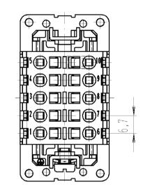
mit Federkraftanschluß with spring connection
