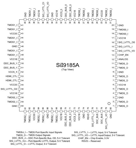
**Figure 2. Pin Mapping**
