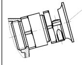
Kabeldurchführung M32 mit Zugentlastung und Biegeschutz cable gland M32 with strain relief and bending protection
